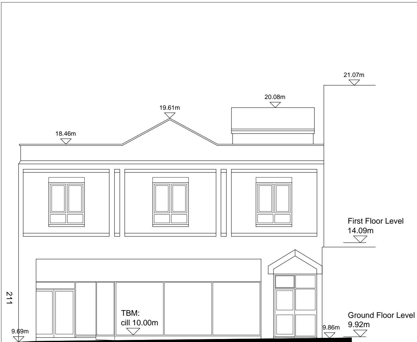
Existing Elevation 1 Datum: 8.00m
